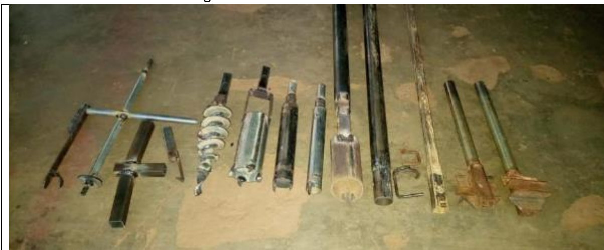
Onderdelen van een Mzuzu boor set gemaakt met lokale materialen.
